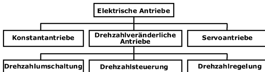
Bild 2-2 Klassifizierung elektrischer Antriebe bezüglich der Drehzahlverstellbarkeit
